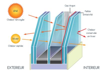
Triple vitrage thermique SP10/4/SP10 FE argon
